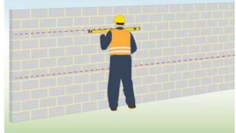
Второй шаг: Используя уровень, разметьте места, где планируется устанавливать габионы. Поверхности должны быть ровными.
