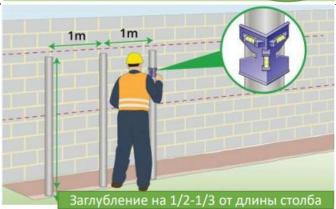
Четвёртый шаг: Посредством уровня разместите опорные балки с интервалов 1 метр непосредственно под местом установки габионов.
