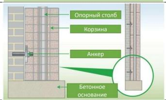
Общий принцип отделки фасадов габионами: Данная инструкция по монтажу применима для сварных габионов шириной более 40 см. Если используются более узкие сетчатые короба, то опорные столбы заменяются на крепёжную рейку, а количество анкеров не менее 3 шт на 1 кв.м.
